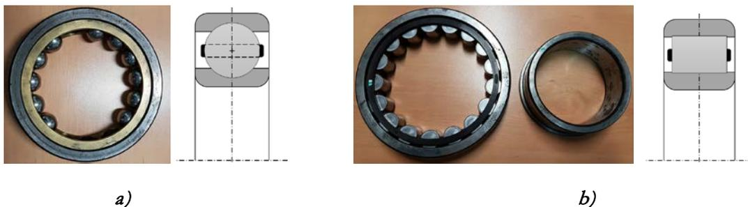
*Figura 6. Rodamientos: a) de bolas b) de rodillos cilíndricos.*
