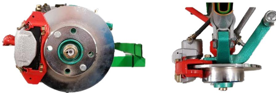
**Figura 13. Freno de disco de un automóvil.**
