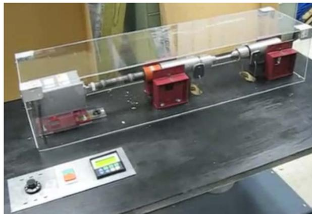
*Figura 20. Ensayo de fatiga con probeta rotatoria de Moore.*
