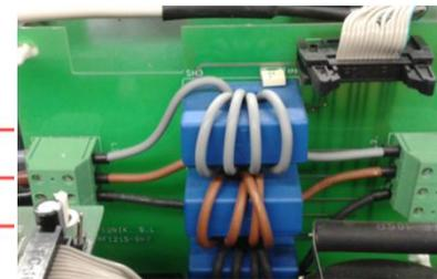
Sensores LEM de corriente de fase con aislamiento galvánico
