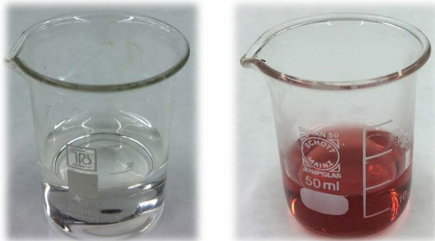
Figura 1.2 Disolución inicial de oro (a) y aspecto final de la misma tras la formación de las nanopartículas.
