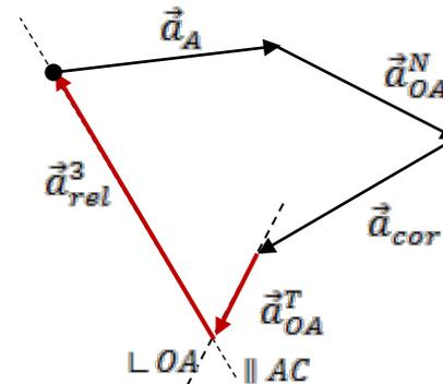
3. Planteo la condición de rodadura pura en aceleraciones:  $(\vec{a}_{c_2})^{\parallel AC} = (\vec{a}_{c_3})^{\parallel AC}$
