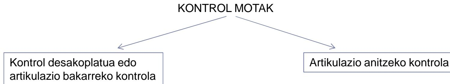
Robotaren eredu **artikulazio independentez** osatutakoa dela onartzan da, euren arteko elkarrekintza kontuan izan barik. Kasu honetan, eragingailuaren eredu motor elektrikoa bat da.
