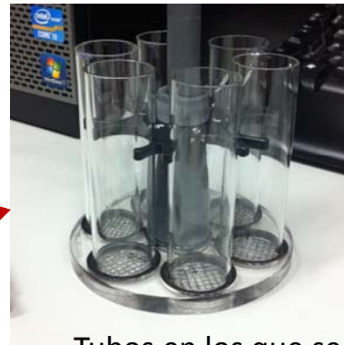
Tubos en los que se introducen los comprimidos
