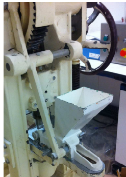
Detalle de la tolva situada en la parte trasera de la máquina
