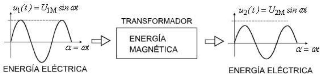
Figura 10.1: Cambio en la amplitud de la magnitud eléctrica realizado por el transformador.
