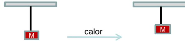
El caso del elastómero es diferente del metal. Así, al someter a un elastómero a un peso constante, éste se deforma con facilidad. Al estirarse cambia de conformación pero no varía su ángulo de enlace, lo que hace que la entropía del sistema se reduzca y, por lo tanto, disminuya el número de las conformaciones accesibles.
