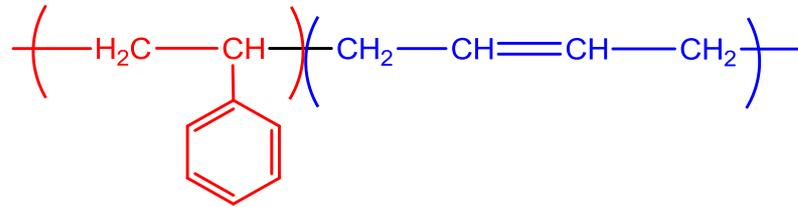
A temperatura ambiente el bloque de poliestireno es rígido ( $T_g = 100^\circ\text{C}$ ), mientras que el bloque de polibutadieno es flexible ( $T_g = -90^\circ\text{C}$ ). Al aplicar un esfuerzo se produce un cambio conformacional en el bloque elástico mientras que el rígido evita el desplazamiento de las cadenas y permite recuperar la forma original.
