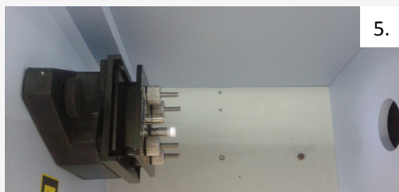
5. Paso de luz a través de la muestra (vista superior).
