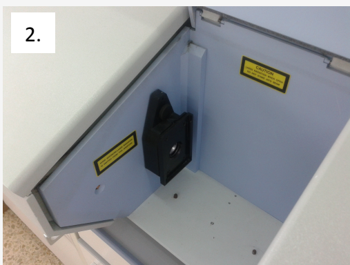
2. Paso de luz y compartimento para ubicar las muestras.
