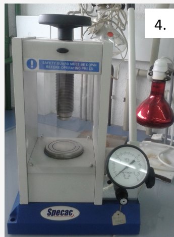
4. Preparación de una muestra sólida en pastilla de KBr. La mezcla se prensa para convertirla en una pastilla que se coloca mediante el soporte adecuado en el camino del haz de luz.
