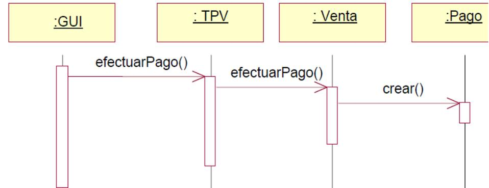
El diseño (2) tiene acoplamiento más bajo:
