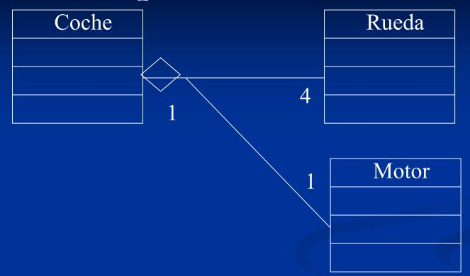
En este S.I. no se permite tener "motores" ni "ruedas" sueltos, y al borrar el coche, se borra todo...
