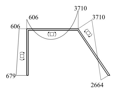
**5.4.** La figura muestra una estructura en la que A y C son empotramientos perfectos y B una rótula intermedia en la que actúa una carga vertical P=700 KN. El material es un acero de módulo de elasticidad E=210 GPa y la sección es constante, de momento de inercia l=96000 cm<sup>4</sup>.
