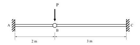
En este caso son 7 los grados de libertad de la estructura (figura inferior), siendo  $\Delta_3$  común a ambos elementos.
