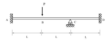
La estructura puede considerarse formada por tres elementos viga biempotrada cuyos nudos y grados de libertad se indican en la figura. Su rigidez a flexión tiene el valor:
