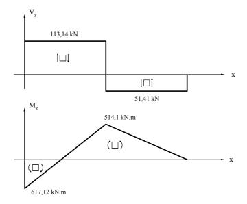
**5.6.** En la viga de la figura, A y D son empotramientos perfectos y C una articulación deslizante. En ella L=1 m, la sección es constante de momento de inercia l=1000 cm<sup>4</sup> y el material tiene un módulo de elasticidad E=200 GPa. Está sometida a una carga vertical en B de 100 KN.
