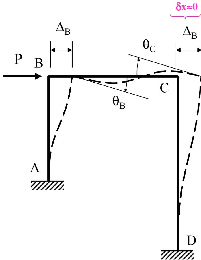
Si se desprecia el efecto del esfuerzo axial en la deformación de las barras, los nudos B y C, debido a la carga P, experimentarán un desplazamiento horizontal del mismo valor  $\Delta_B = \Delta_C$
