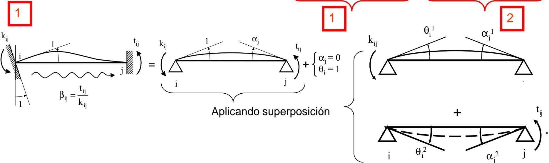
$$\alpha_j = \frac{K_{ij}L}{6EI} - \frac{t_{ij}L}{3EI} = 0 \Rightarrow t_{ij} = \frac{K_{ij}}{2} \Rightarrow t_{ij} = \frac{2EI}{L} \Rightarrow \beta_{ij} = \frac{t_{ij}}{K_{ij}} = \frac{1}{2}$$
