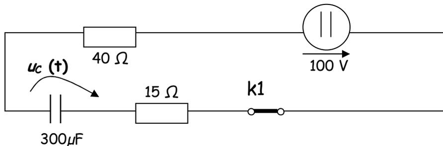
Si tenemos en cuenta que el condensador no admite cambios bruscos de tensión y que en el régimen permanente se comportara como un circuito abierto por el que no circulara corriente, en régimen permanente la corriente que circula por el circuito es nula y toda la tensión de la fuente caerá en el condensador, por ello:
