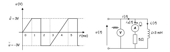
Al circuito de la figura se le aplica la función u(t) representada. Determínese:
