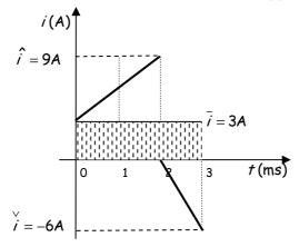
Lectura del amperímetro: Es el valor medio de la corriente total, geométricamente en un periodo, el área del rectángulo debe ser igual al área de la función.
