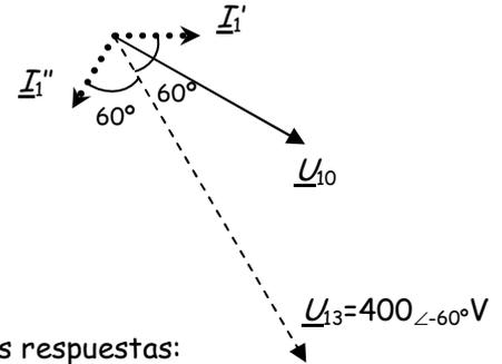
Al igual que en el otro caso de la lectura del vatímetro, hay dos posibles respuestas: Que la corriente  $\underline{I}'$  esté  $60^\circ$  adelantada respecto a la tensión, o  $\underline{I}''$ , que está  $60^\circ$  atrasada.
