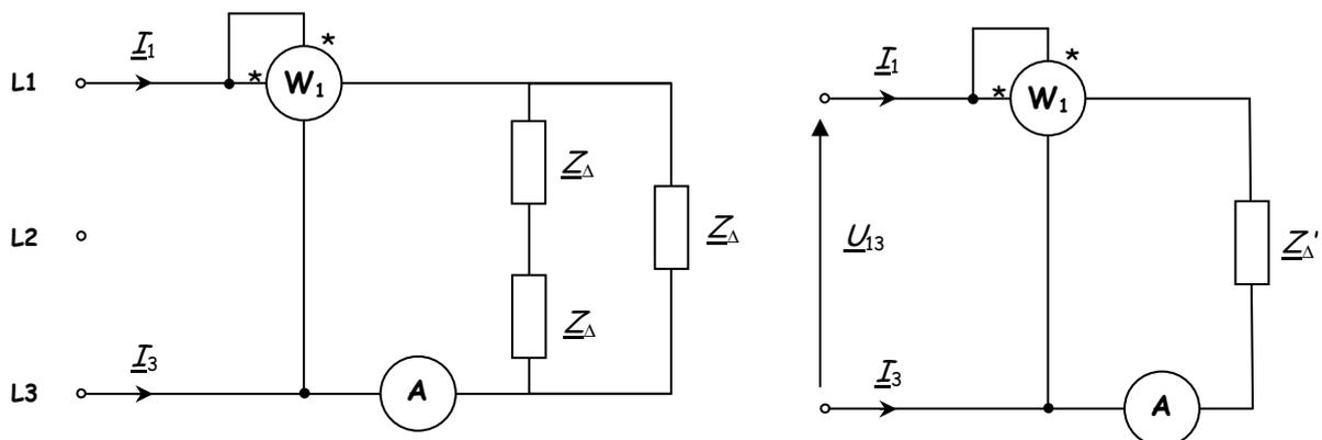
El triángulo en el circuito monofásico se convierte en dos ramas en paralelo. Y se puede obtener su impedancia equivalente:
