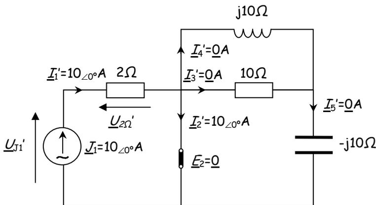
Las corrientes se obtienen de inmediato. Ya que aparece un cortocircuito en la rama de la fuente de tensión, y la toda la corriente de la fuente se va por esa rama ( $\underline{I}_2' = 10\angle 0^\circ \text{A}$ ), y el resto de corrientes de rama son nulas  $\underline{I}_3' = \underline{I}_4' = \underline{I}_5' = 0 \text{A}$ .
