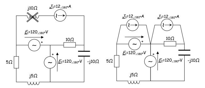
La fuente de corriente que queda en paralelo con la fuente de tensión se elimina, y la otra se transforma en fuente real de tensión:
