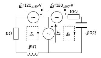
$$\begin{bmatrix} 5 + j5 & 0 \\ 0 & 10 - j10 \end{bmatrix} \begin{bmatrix} \underline{I}_{\mathcal{A}} \\ \underline{I}_{\mathcal{B}} \end{bmatrix} = \begin{bmatrix} 0 \\ 240_{\angle 180^{\circ}} \end{bmatrix}$$
