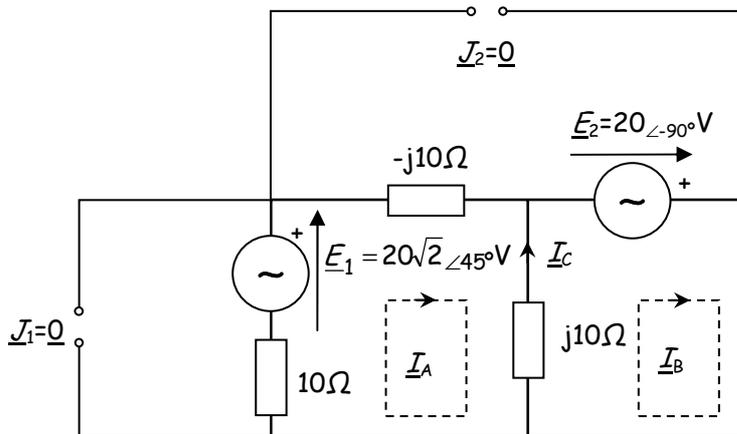
$$\begin{bmatrix} 10 & -j10 \\ -j10 & j10 \end{bmatrix} \begin{bmatrix} \underline{I}_A \\ \underline{I}_B \end{bmatrix} = \begin{bmatrix} 20 + j20 \\ -j20 \end{bmatrix}$$
