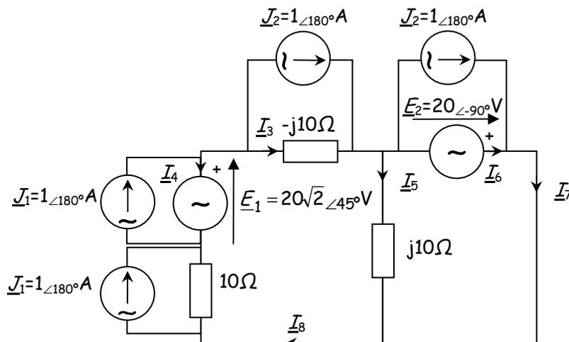
Si hay fuentes ideales de tensión en paralelo con fuentes ideales de corriente pueden ser eliminadas las de corriente. Si hay fuentes de corriente reales se pueden transformar en fuentes reales de tensión:
