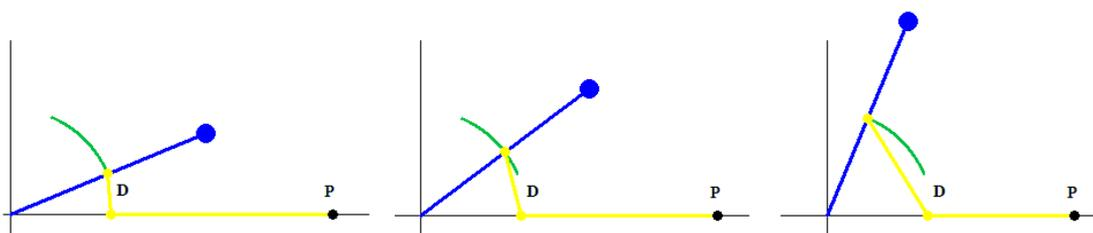
40. Construir un modelo de máquina de coser. Encontrar la trayectoria y del extremo  $P$  de la aguja, conectada mediante una biela a un volante giratorio (ver figura). Hay que dar valores a los diferentes parámetros del mecanismo (radio del volante, longitud de la biela y de la aguja, en cm) y encontrar  $y(\theta)$ , siendo  $\theta$  el ángulo de giro de la circunferencia.
