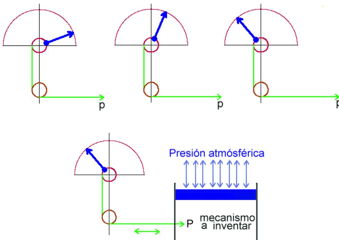
Luego, inventar un mecanismo para convertir el desplazamiento vertical provocado por la presión atmosférica en el movimiento horizontal de P. Encontrar la función que nos da la posición sobre la escala a partir del desplazamiento vertical. Tened en cuenta que los desplazamientos horizontal y vertical serán realmente pequeños.
