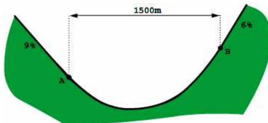
33. Para construir una autopista hay que salvar un valle cuyas laderas son tramos rectos que tienen pendientes del 6% y del 4% (ver figura). En un principio se pensó en construir el tramo que une los puntos fijos A y B mediante una trayectoria parabólica, como en el problema anterior, pero se descartó la idea. Explica por qué. Así pues, ¿en qué se diferencia este problema del anterior? Finalmente se optó por una trayectoria cúbica. Calcula su ecuación.
