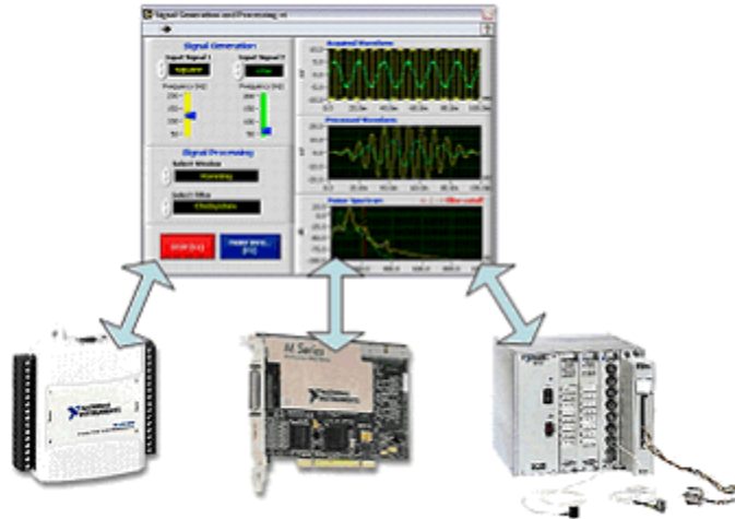
Fig. 2. Actualizar el hardware es fácil al utilizar la misma aplicación para muchos dispositivos.
