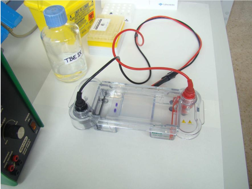
4. Colocar la tapa a la cubeta y seleccionar la intensidad de la corriente eléctrica (habitualmente entre 75 y 100 V).
