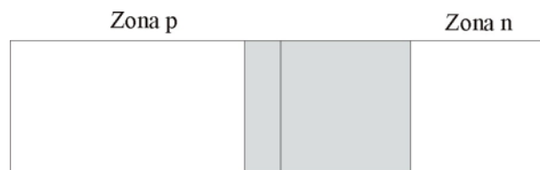
Figura 2.6.- En la figura se aprecia como la zona de carga (área sombreada) penetra más en la zona n (menos dopada) que en la zona p (más dopada).
