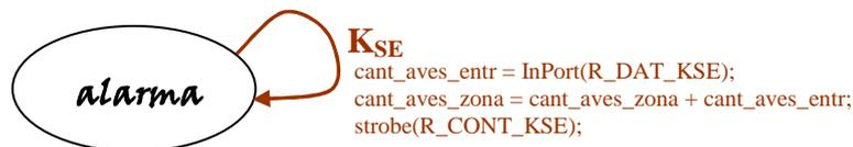
Y en la rutina de servicio del sensor SE no debemos modificar la acción SE.4, puesto que ya habíamos tenido en cuenta que el cambio del color del semáforo y la transición de estado sólo deben producirse en el estado *normal*.
