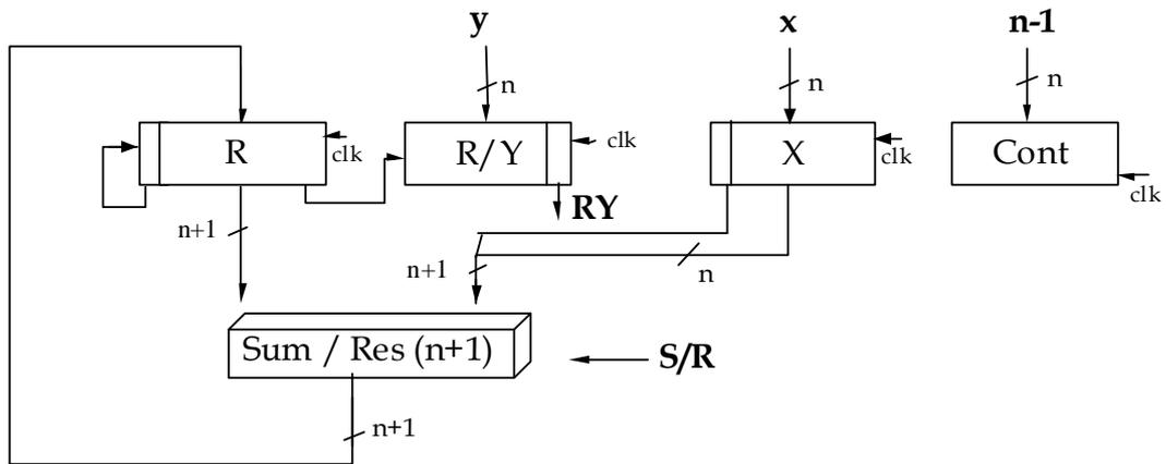
Utilizando este circuito, el algoritmo de multiplicación de  $n$  bits es el siguiente:
