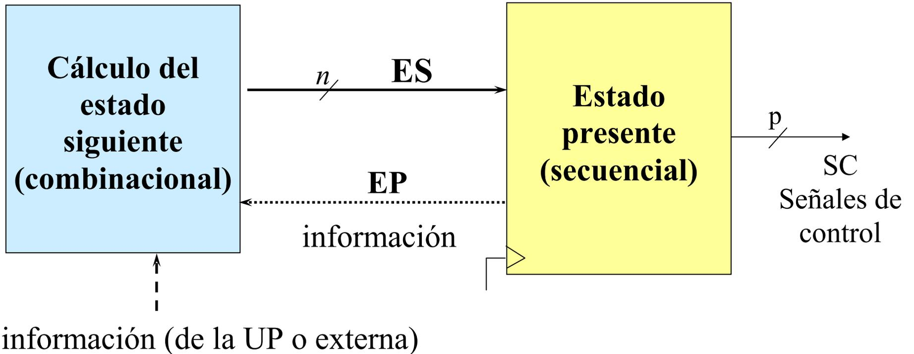
Especificación del funcionamiento: algoritmo de control
