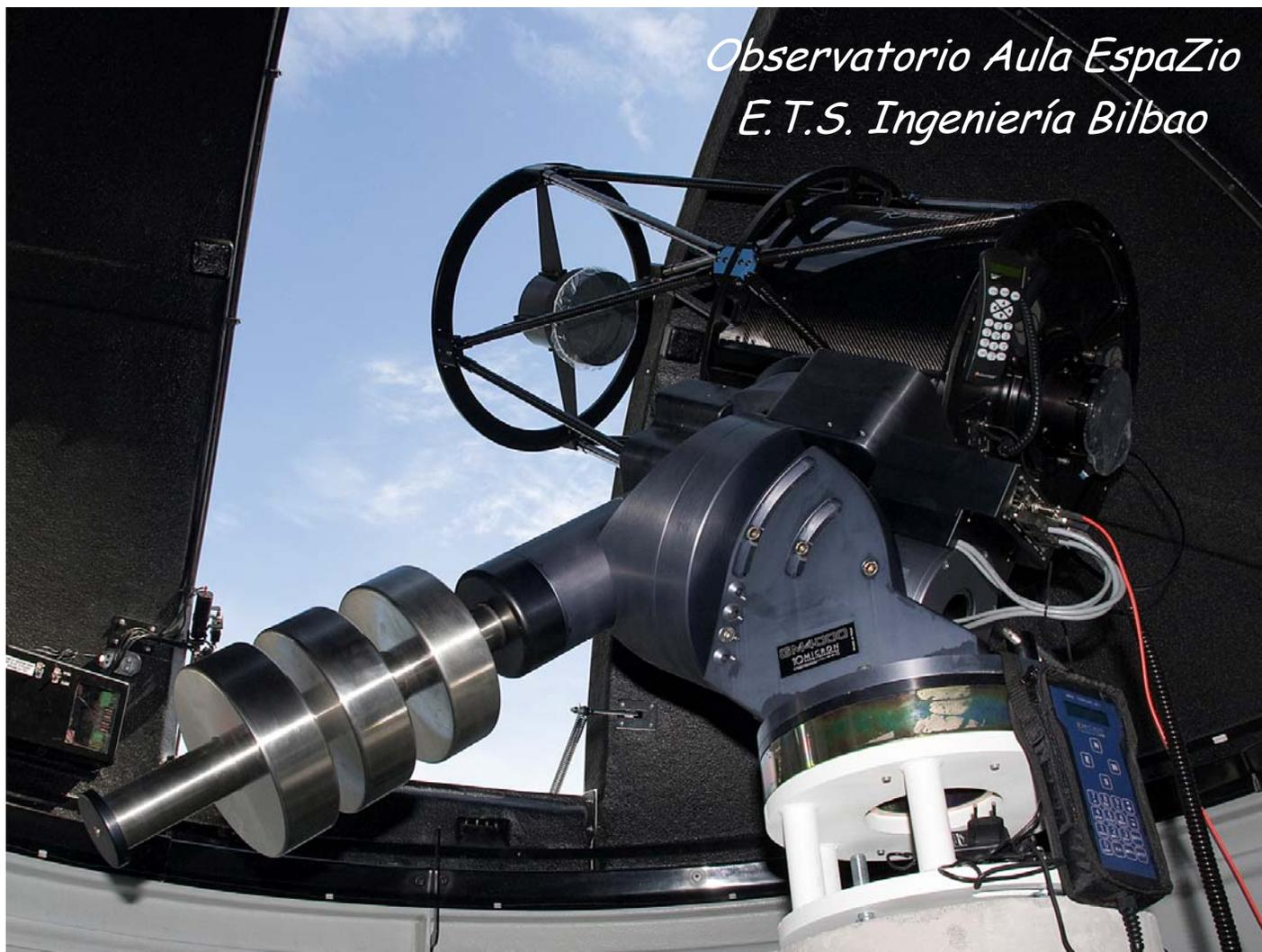
Datos: 50cm de abertura, 3.454mm de focal, montura ecuatorial alemana
