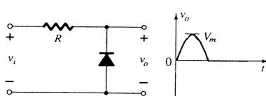
Recortadores polarizados en paralelo (diodos ideales)
