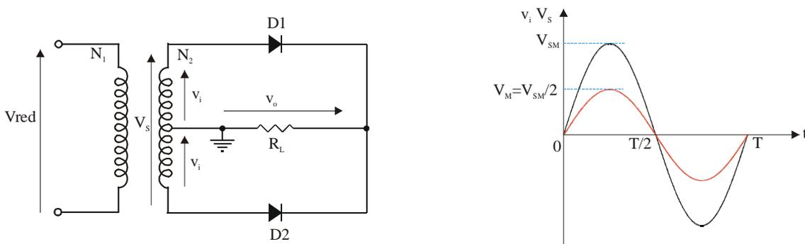
En la figura aparece el circuito para obtener un rectificado de onda completa utilizando únicamente dos diodos. Notar que para poder hacer este tipo de rectificado se necesitan dos tensiones idénticas  $v_i$ , lo cual se consigue fácilmente con un
